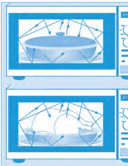
Figura 1. Cómo se reflejan las ondas electromagnéticas del microondas (Tomada de Gil de Antuñano, 2009).
